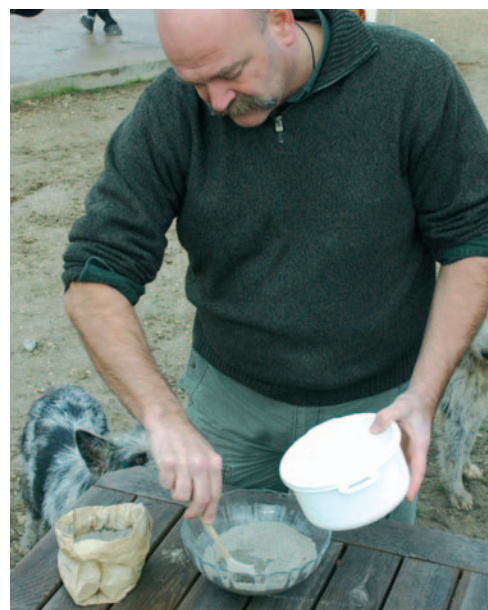
Per preparare la pasta d'argilla si meschia la polvere con acqua, in un recipiente, possibilmente di vetro. Si amalgama il tutto fino a ottenere un impasto morbido e omogeneo
